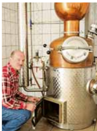
Zwetschgenwasser, Obstler und Williams Christ – das Etikett mit dem Hofnamen „Schlossbauer“ steht für die Erzeugnisse von Anton Riedlberger aus Schiltberg. Bei der Herstellung setzt er auf eine Wasserbad-Brennanlage.
